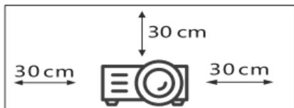
4、安装在远离墙壁的位置为了维护投影仪的性能和可行性，请在投影仪与墙壁之间至少留30cm的空间。
